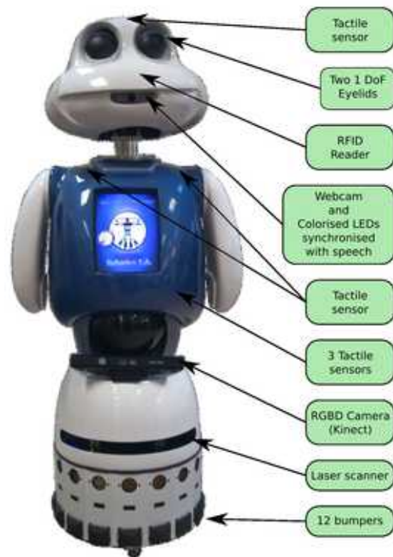
Fig. 1 The hardware equipping Maggie.
