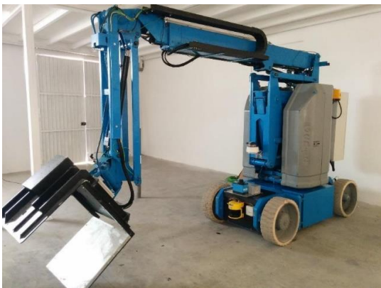
Figura 3. Vehículo y grúa extensible del sistema robótico.
