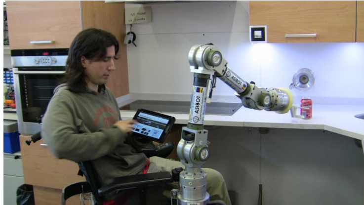
Fig. 1. Operador explicando el funcionamiento de la interfaz web, en un entorno doméstico perteneciente a la Universidad Carlos III de Madrid. El manipulador ASIBOT que se ve en la figura asiste a la persona en silla de ruedas.
