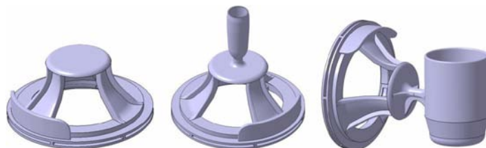
Fig. 3 Portaherramientas para el robot ASIBOT
